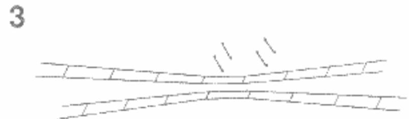
Knicken Sie die beiden Fahrdrähte jeweils an den beiden mittleren Hänger (Hängerabstand = 45 mm) vorsichtig soweit ab, dass sie dem Gleisverlauf entsprechen.
