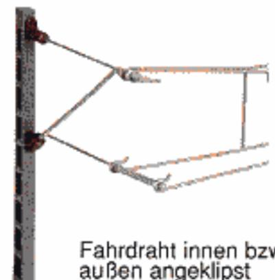
Fahrdraht innen bzw. außen angeklipst
