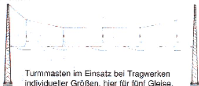
Turmmasten im Einsatz bei Tragwerken individueller Größen, hier für fünf Gleise.
