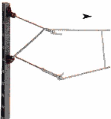
Durch leichtes Ziehen in Pfeilrichtung wird der Fahrdraht am Ausleger fixiert.
