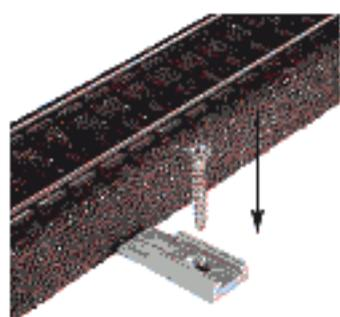
Nach dem Kürzen des Grundträgers wird er seitlich an das Gleis gesetzt. Anschließend kann er mit der beiliegenden Senkkopfschraube in dem bereits vorgebohrten Loch angeschraubt werden. Dabei ist die Verwendung des Spezialschraubendrehers 4199 empfehlenswert.
