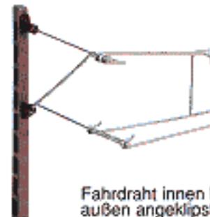
Fahrdraht innen bzw. außen angeklipst
