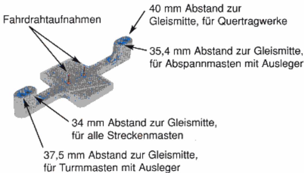
An den Positionslehren befinden sich je zwei Stifte, die zur Fahrdrahtaufnahme dienen. Die seitlichen Bohrungen dienen zur Fixierung der Lehre und zur Markierung der ermittelten Mastposition.
