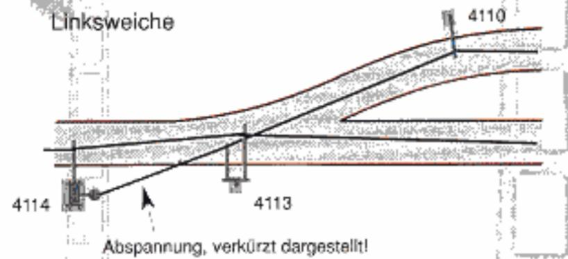
Der Profi überspannt die Weiche mit Hilfe eines Doppelauslegers 4113, der die sich kreuzenden Fahrleitungen aufnimmt (siehe Abbildung unten). Die Fahrleitung, die die gerade verlaufende Hauptleitung durchkreuzt, wird nach außen abgespannt und an einem Festpunkt verankert. Als Festpunkt kann zum Beispiel ein Abspannmast 4114 bzw. ein Rad- oder Hebelspannwerk (4164 bzw. 4165) eingesetzt werden.
