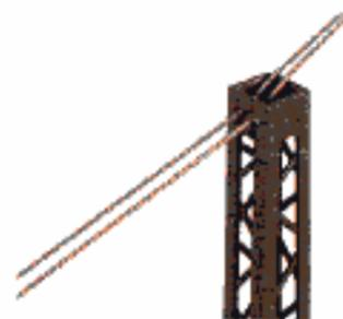
Hängen Sie nun das Quertragseil in die dafür vorgesehenen Kunststoffteile ein und sichern Sie es, indem Sie die Bodenplatte jedes Elementes nach oben schieben. Sollte sich dann das Quertragseil als zu lang erweisen, kann es an den Enden noch etwas gekürzt werden.
