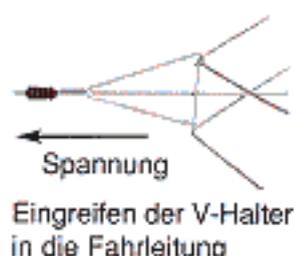
Der Bogenabzug 4122 ist universell zum Überspannen von ein bis drei Gleisen einsetzbar.
