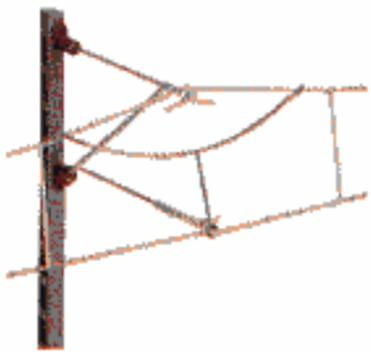
Eine weitere Möglichkeit zur Erzeugung von Halteabschnitten ist die Verwendung von Fahrdrahttrennern (4175). Dabei werden die Enden der Blockstrecke mit je einem Fahrdrahttrenner versehen. Die Fahrdrähte werden wie gewohnt an den Streckenmasten 4110 eingehängt und zusätzlich mit Y-Seilen verbunden. Die Stromversorgung des Halteabschnittes erfolgt durch einen Anschlussmast 4111, der je nach angezeigtem Signalbegriff die Spannung ab- oder zuschaltet.
