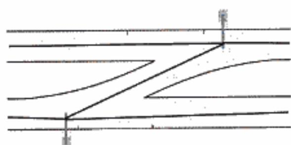
Die Überspannung zweier kombinierter Linksweichen erfolgt analog zu der Überspannung einfacher Linksweichen mittels zweier Streckenmasten 4110. Diese Streckenmasten nehmen sowohl den abzweigenden Fahrdrabt als auch die Fahrdrähte der Stammgleise auf.
